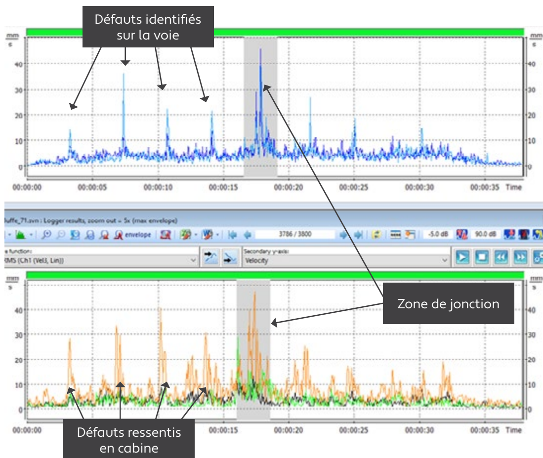
Figure 4 – Au-dessus Vibration RMS en mm/s mesurées sur les galets, au-dessous Vibration RMS en mm/s sur le siège conducteur
